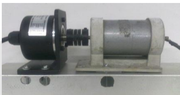
شکل ۱۲- شفت انکودر افزایشی متصل به یک موتور DC
